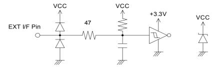
Fig. EXT I/F input circuit
